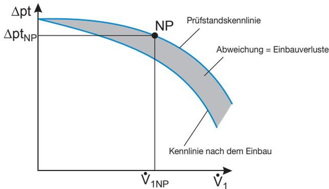
Um die Einbauverluste möglichst klein zu halten, sind folgende häufig auftretende Störquellen zu vermeiden:
