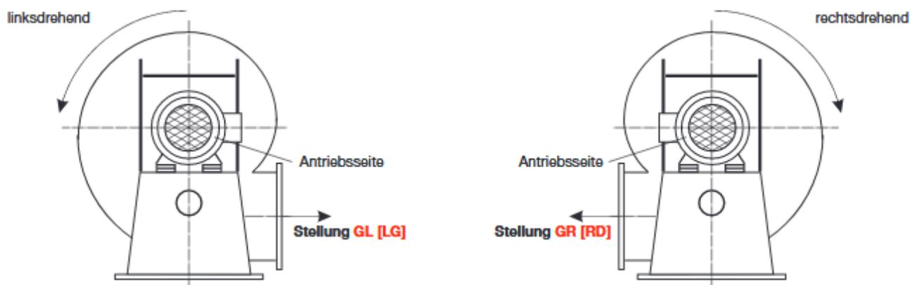
Abb. 64: Ventilator-drehrichtung
